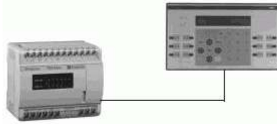
Conexión de un visualizador a un autómata
